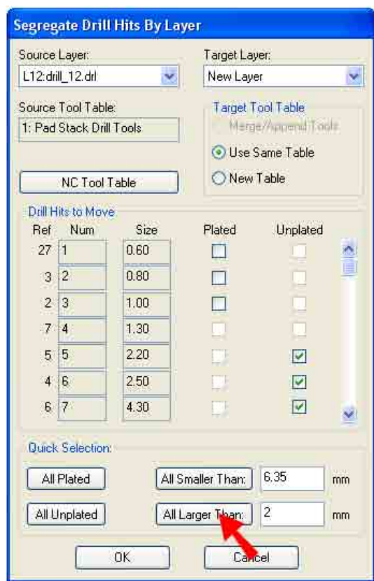
Рис. 13. Разделение отверстий из одного слоя на два в соответствии с указанным признаком (например, все отверстия диаметром больше 2 мм будут помещены в новый слой)
