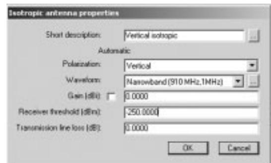
**Рис. 10. Окно установки параметров антенны**
