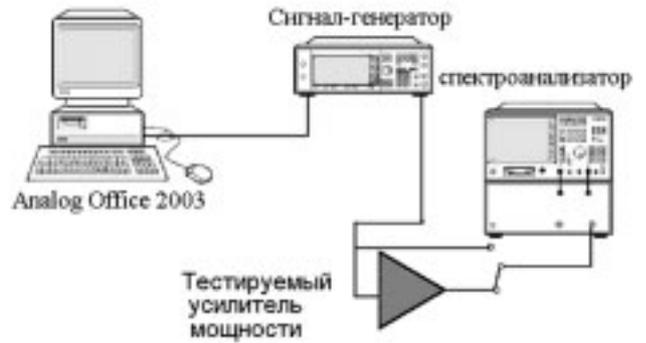
**Рис. 15. Схема экспериментального измерения параметра АСР**
